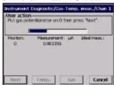
该特征允许您检查 EC 测量板测量电流和温度范围的能力。如果使用该功能，必须使用 EC 传感器的模拟器（部件号：32304）来取代传感器。
