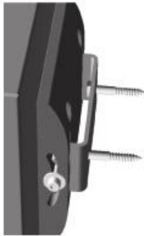
用两个螺丝（不提供）将自带的 U 型支架固定在墙上。
