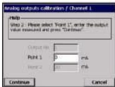
使用电表测量第一点的电流值，应该是在 4mA 以下。
