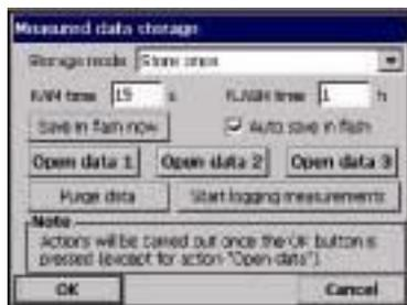
这个对话框允许用户对记录和存储测量值的参数进行调节。根据用户所选的测量模式，有两种存储方式可供选择。（见第 36 页的“仪器配置”）。
