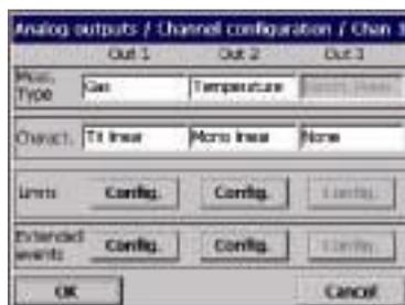
授权用户可以最多可以对每个通道的每三个输出定义 12 个自定义事件，并可以根据这些事件的优先性调整顺序。
