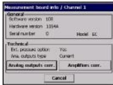
仅供参考，该显示可以为您提供选定测量通道的测量主板的硬件、软件信息。
