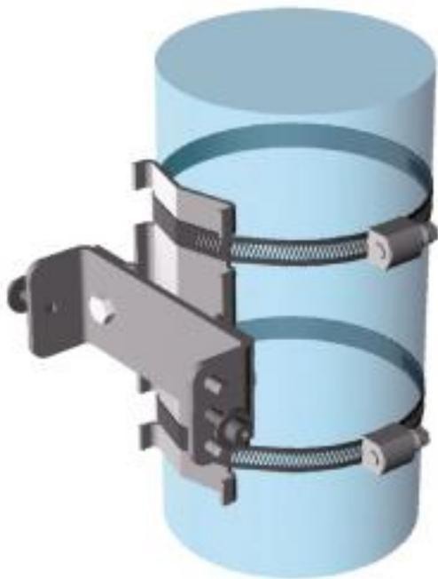
使用自带的两个螺丝，将管道式安装支架和 U 型支架装配在一起。
