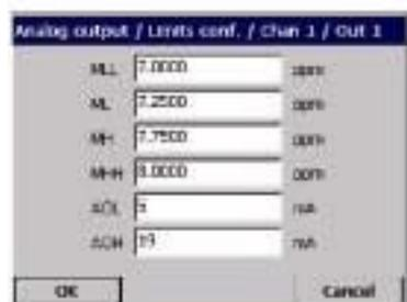
☐ 限值：按下配置键，可以调节模拟输出设定点。在合适的文本框中输入数值。在单线性模式下，仅有 ML 和 MH 可以调节。三线性模式中，所有的限值都能调节（如左侧所示），使用无线性模式时，不能获取该显示屏。
