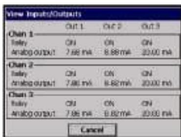
对于每一个通道，这个测试窗允许您检查 3 个警报继电器的实际状态以及 3 个模拟输出电流值。（或电压，取决于仪器的类型）。
