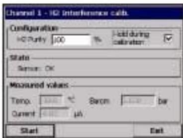
该校准仅在传感器测量氧气浓度时可用，而且还需要氢气干扰被激活。（见第 42 页的“氧气干扰配置”）。屏幕底部显示的是实际测量值。
